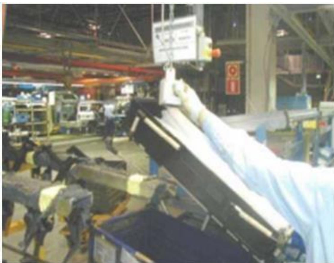
Figura 2 – Acionamento do sinal luminoso
